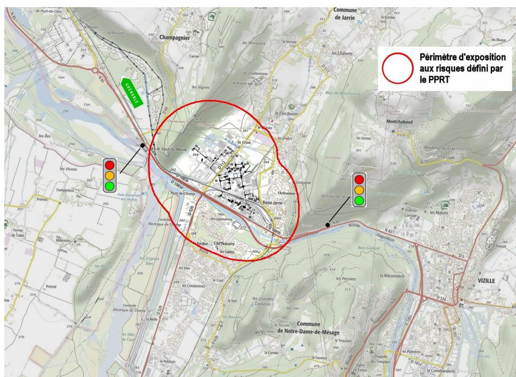
Ces feux, couplés à des capteurs sous chaussée et pilotés par le PC Gentiane-Métromobilité, visent à garder la zone de risque (au niveau de l'autopont) fluide en déplaçant en dehors de cette zone les bouchons actuellement observés.
